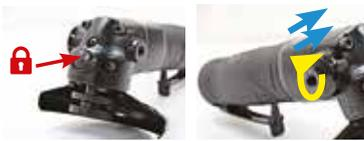
Botón de desbloqueo del disco. Escape lateral ajustable que permite enviar el aire en la dirección deseada.
