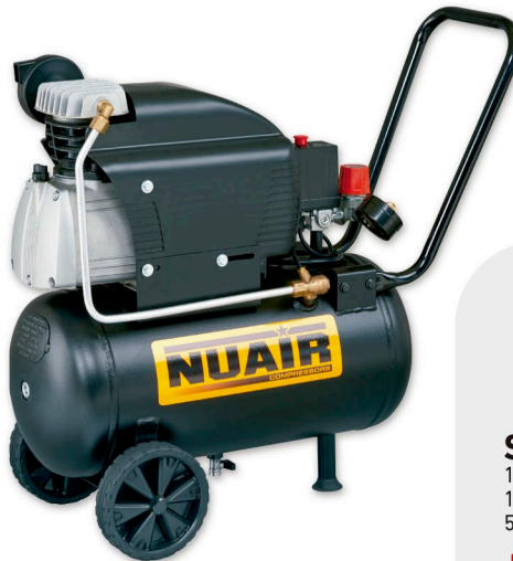
FC2/24S Nuair 2 hp caldera 24 lts. 222 lts./min. 230V II. 8 bar. Con aceite.
