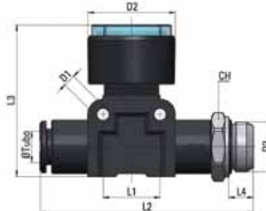
Versión automática con rosca Push-in/thread version
