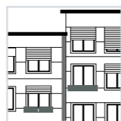
▪ Juntas de dilatación
