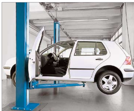
Sistema asimétrico, que permite abrir las puertas ampliamente
