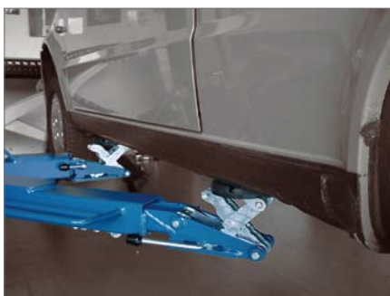
MINI-MAX: Tacos de apoyo extensibles que se ajustan con el pie. Evite agacharse
